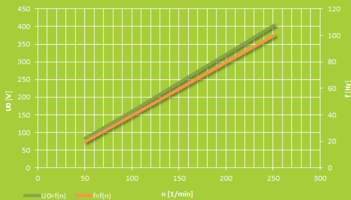
Spannung und Frequenz in Abhängigkeit zur Geschwindigkeit für eine Schaltung mit zwei parallelen Zweigen
